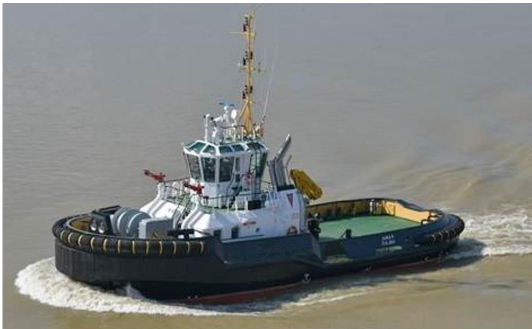
Figura 08 – Exemplo de Rebocador ASD – para Apoio Portuário de 60TBP.
